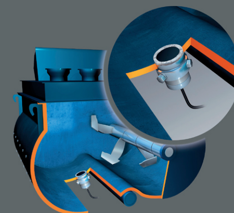
Installation dans la cuve d'un mélangeur horizontal.
