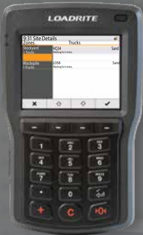
Liste des travaux sur le LR360 affichée en temps réel en cabine.
